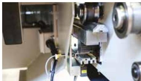
Die Struktur des Grundkörpers, der feste Arbeitstisch, die Gleitschienen der Brücken mit einem Querschnitt von 50x50 mm, garantieren Zuverlässigkeit auf lange Zeit.
